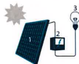
1 Zonnepaneel | 2 Omvormer | 3 Elektrische toestellen
